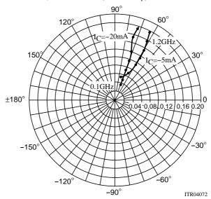
**S parameter** S21e: V<sub>CE</sub>=-10V f=100MHz, 200 to 1200MHz(200MHz step)
